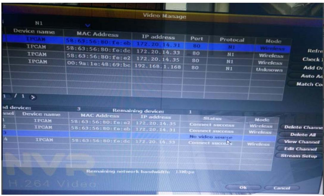
Nach dem Löschen klicken Sie auf Refresh oder Aktualisieren. Markieren Sie nun die neue Kamera (Mode Unknown/Unbekannt) und klicken auf Match Code oder Kodierung. Das muss mit Yes/Ja bestätigt werden und dauert 2-3 Minuten.
