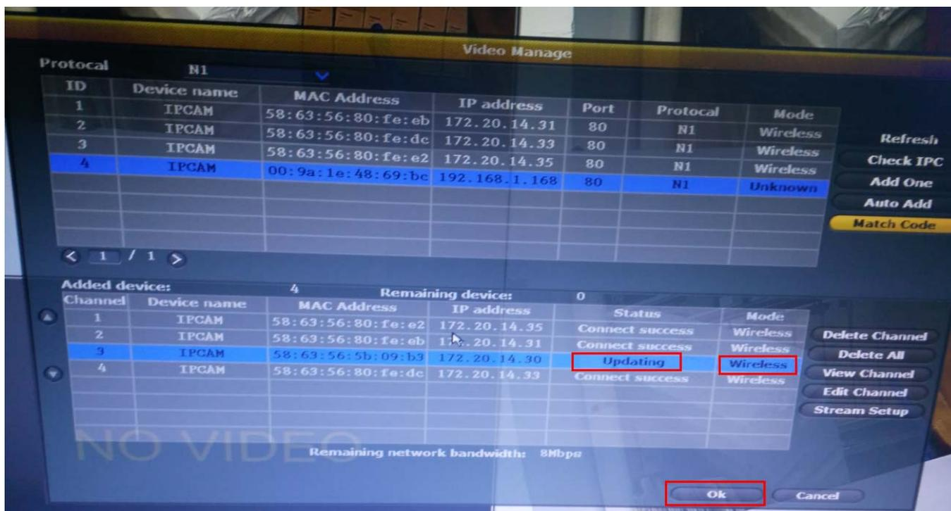
Nach Match code done oder Kodierung Fertig. Stecken Sie das LAN Kabel ab, nun sollten sie ein Bild an Kanal 3 haben.
