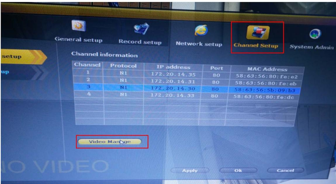
Bei einem Kamera Tausch: Löschen Sie den Kanal der nicht erreichbar ist. "Channel 3"
