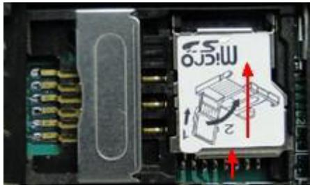
bei unserem Trackermodell besteht zusätzlich die Möglichkeit eine Mini-SD-Speicherkarte einzulegen, auf der Daten zwischengespeichert werden, falls die Verbindung abreißt. Der SD-Kartenslot befindet sich unterhalb der SIM-Kartenhalterung. Um eine SD-Karte einzulegen ziehen Sie vorsichtig an der weißen Lasche die Halterung nach oben. Die Halterung ist etwas schwergängig und es bedarf etwas Fingerspitzengefühl.
