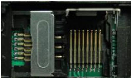
hier die nach oben geklappte Halterung. Legen Sie die SD-Karte ein und klappen dann die Halterung wieder nach unten.
