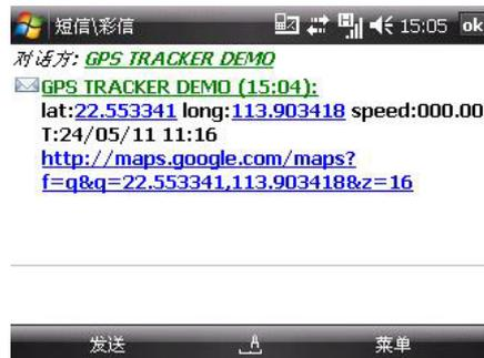
\*Verfolgung der Position: Wenn das GPS-Signal verschwindet, enthält die SMS die letzte gültige Breite und Länge. Bitte beachten Sie die Sendezeit der SMS.
